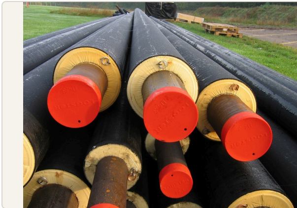
Mike1024, „Pre-installation insulated underground pipes for district heating”, Wikimedia Commons, közkincs – átméretezve · Az előszigetelt cső felépítése: a nedvesség a habba jutva sokszorosára növeli a hőleadást.
